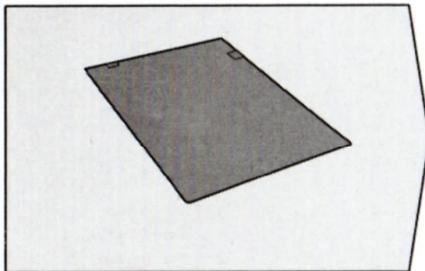
1. Legen Sie die Wärmematte mit der Rückseite nach oben flach auf dem Boden aus.
