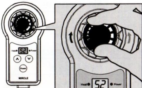
3. Zum Verringern der Temperatur drehen Sie das Einstellrad des Thermostats (2) entgegen dem Uhrzeigersinn, die jeweils eingestellte Temperatur wird wiederum im Display (6) angezeigt.
