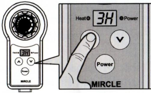
1. Mit den Tasten V bzw. Timing V (Timer abwärts) (5) und ^ bzw. Timing ^ (Timer aufwärts) (8) stellen Sie die Laufzeit des Timers ein.
